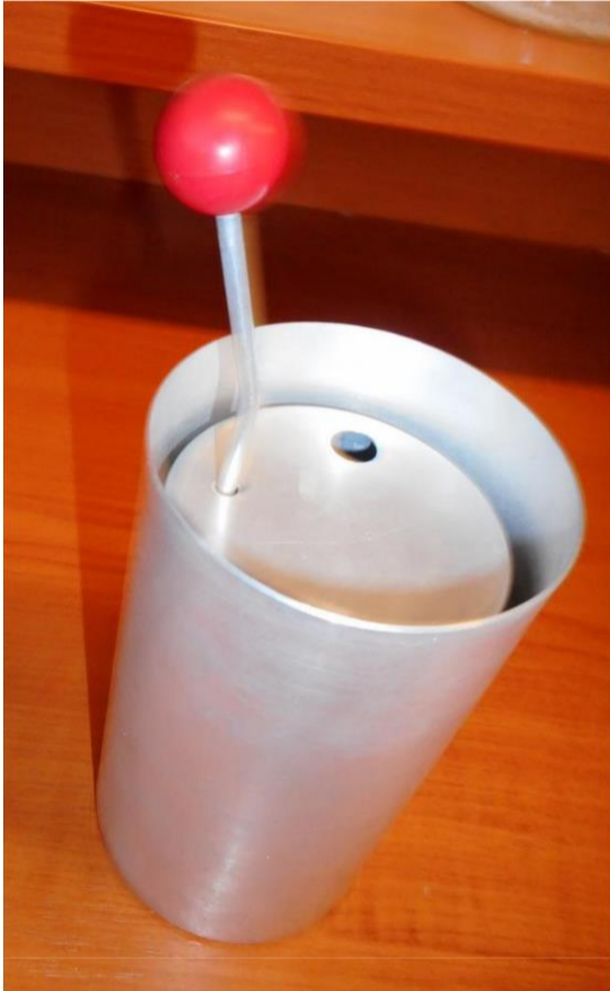
kaloriméter (hőkapacitása C = 124 \text{ J/}^\circ\text{C} )
