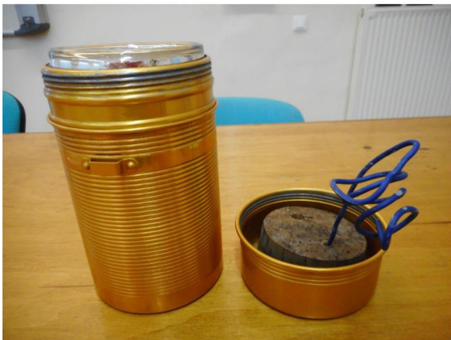
kaloriméter (hőkapacitása C = 120 \text{ J/}^\circ\text{C} )
